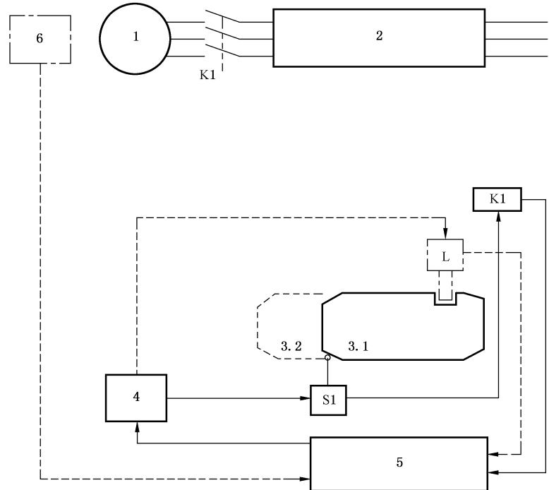
K1——带联接或镜像触点的接触器；
